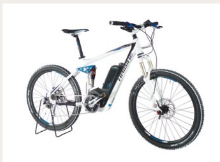
Haibike EQ Xduro Pedelec 25. · Vollgefedertes Mountainbike, herumgebaut um die vorgegebenen elektrischen Komponenten von Bosch .
