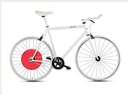
Copenhagen Wheel Pedelec 25 zum Nachrüsten. Nicht der Antrieb steht im Vordergrund, sondern das Erfassen von Messwerten zur Luftqualität und die Vernetzung mit Datenbanken und anderen Nutzern.
