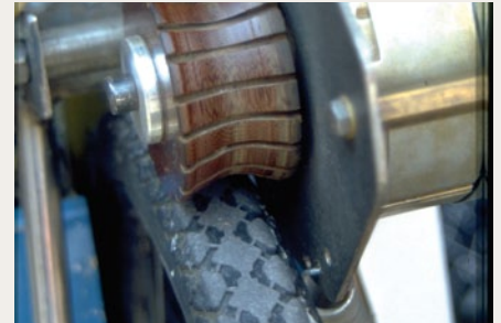
Reibrollenantrieb bei Solarfahrrad des russischen Solarfahrrad-Pioniers Alexander Popolov 1989.
