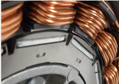
Elektromagnet und Permanentmagnet, das altbewährte Prinzip findet in den meisten LEV-Motoren Anwendung.
