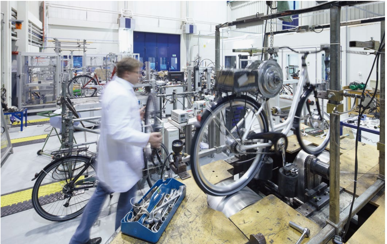
Teststand für Pedelecs des TÜV Rheinlands
